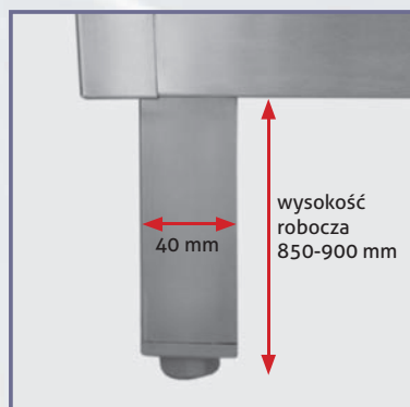
Noga z profilu kwadratowego chromowo-niklowego 1.4301, przekrój 40x40 mm, regulowana -10/+60 mm, łącznie 60 mm. Możliwość zwiększenia wysokości z 850 do 900 mm
